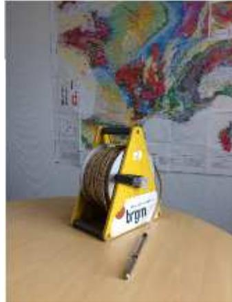
Sonde piézométrique : la partie métallique est plongée dans le puits et sonne au contact de l'eau souterraine. © BRGM
