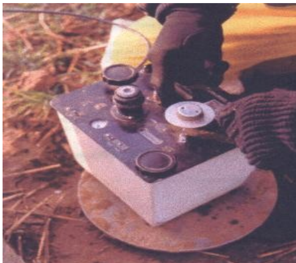
Micro-gravimètre de type Lacoste & Romberg modèle D Source : Site internet de l'Université de Savoie
