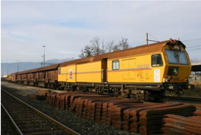
Train meuleur de rails (Scheuchzer S.A.)
