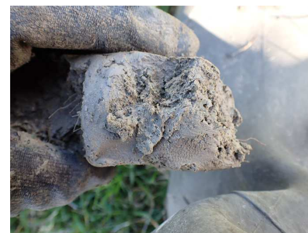
Observation carotte de sol réduit (SCE – 2022)
