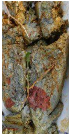
Horizon réductique mis en évidence par l'ortho-phénanthroline
