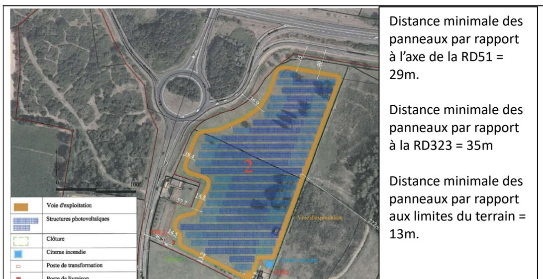
Distance minimale des panneaux par rapport à l'axe de la RD51 = 29m.
